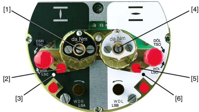
рис. 23: Регулировочные элементы концевого выключателя
