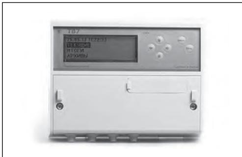
Тепловычислитель предназначен для вычисления и учета тепловой энергии и количества теплоносителя в закрытых и открытых водяных системах теплоснабжения. Тепловычислитель TB7-04 предназначен для работы в составе теплосчетчиков, обслуживающих два теплообменных контура (тепловых ввода TB1 и TB2), представленных трубопроводами: подающий (тр1), обратный (тр2), ГВС, подпитки или ХВС (тр3). В каждом тепловом вводе могут быть установлены 3 датчика объема, 3 датчика температуры и 2 датчика давления.
