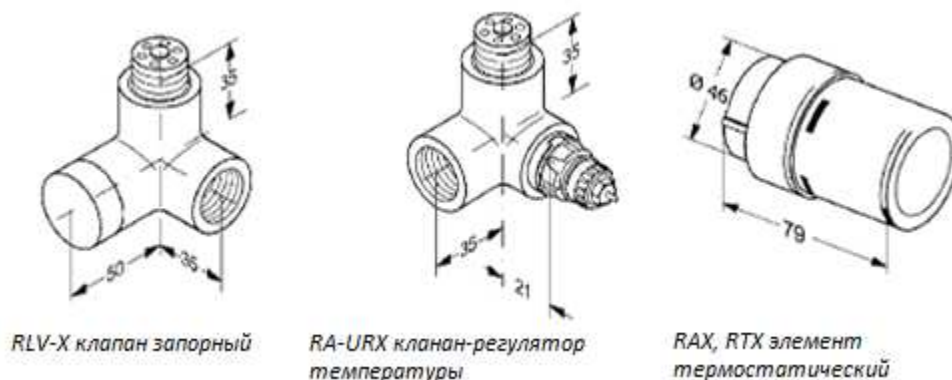
Рис. 3. Габаритные и присоединительные размеры
